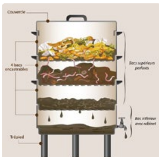
► Fonctionnement d'un lombricomposteur.
